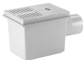
**Typ 5:** Rückstauverschluss, der in Ablaufgarnituren oder Bodenabläufen eingebaut ist, mit zwei selbsttätigen Verschlüssen und einem Notverschluss, wobei dieser Notverschluss mit einem der beiden selbsttätigen Verschlüsse kombiniert sein darf.
