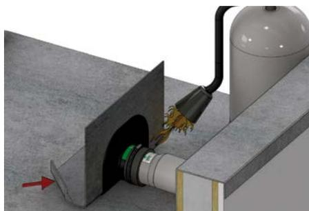
8. Attikatablett mit Anschlussrohr in die Attikaöffnung einsetzen und an die erste Bitumenlage flämmen
