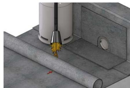
9. Zweite Bitumenlage bis zur Attika auslegen und flämmen
