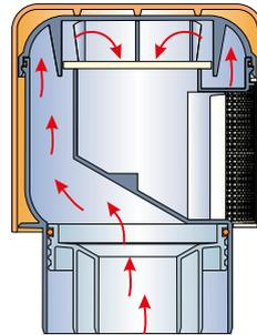
Bei Überdruck im System ist das Belüftungsventil absolut dicht. Es können keine Kanalgase austreten.
