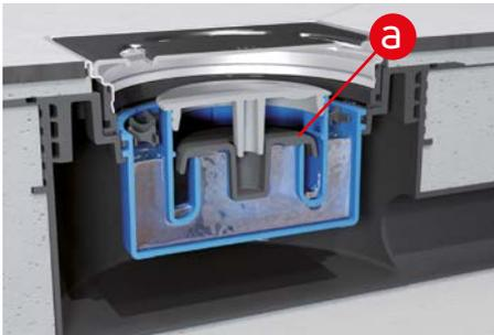
Wenn die Wasserzufuhr beendet wird, verschließt der Ventilteller (a) den Ventil Sitz, das Sperwasser verbleibt im Siphon
