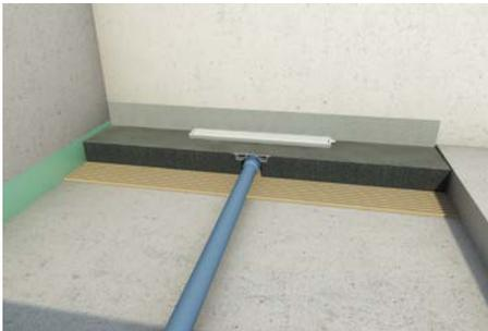
4. Ablauf anschließen, Dichtheitsprüfung
