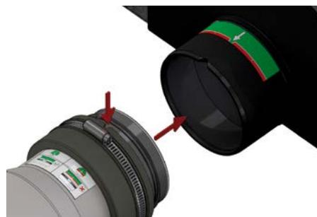
5. Attikatablett und Anschlussrohr verbinden und mittels Schlauchklemme fixieren
