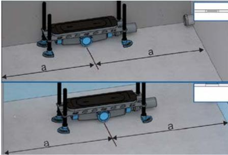
1. Ablaufkörper positionieren und an der Rohbetondecke befestigen
