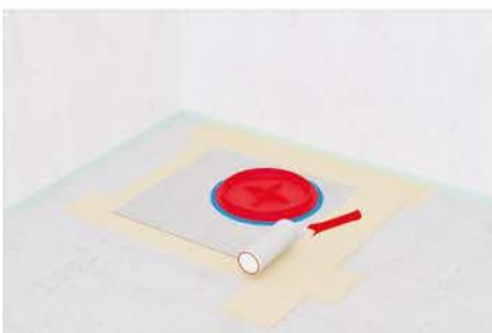
10. Feuchtigkeitabdichtung unter und ober der Dichtmanschette (Sandwichverfahren), sowie im gesamten Duscbereich auftragen. Alle Anschlussstellen mit bauseitigen Dichtbändern versehen.
