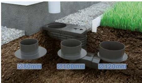
Laubfangkorb: Größer und mit Überlauf-Funktion; sollte der Korb durch Blätter verlegt werden, sorgt das mittlere Aufstandsrohr noch immer für den nötigen Ablauf des Regenwassers.
