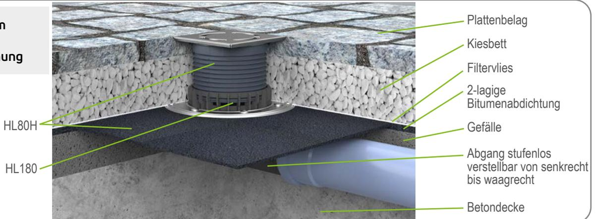
**Terrasse, Platten im Kiesbett verlegt, Wärmedämmung, Umkehrkonstruktion**
