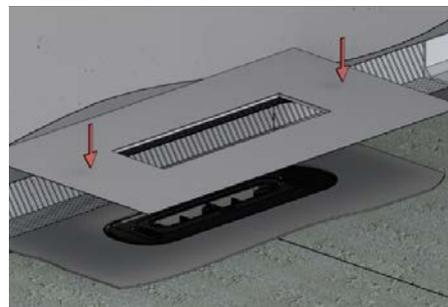
5. Bauschutz entfernen, eventuelle Verschmutzungen beseitigen und Abdichtgarnitur montieren
