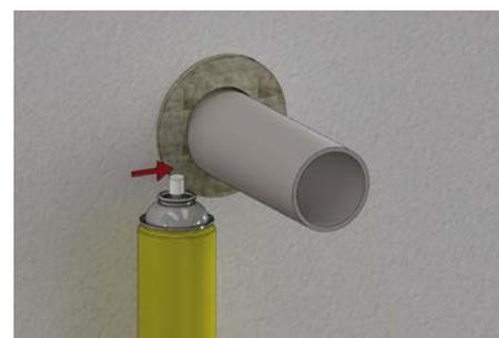
12. Hohlraum zwischen Anschlussrohr und Fassade mit PU-Schaum auffüllen
